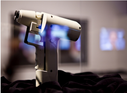
Klassisches Mittel der Gentechnik - die Gen-Kanone schießt Metallpartikel, an denen DNA haftet, in die Zelle (Foto: Kristof Vrancken / Z33. flickr, creativecommons.org/licenses/by-nc-nd/2.0)
